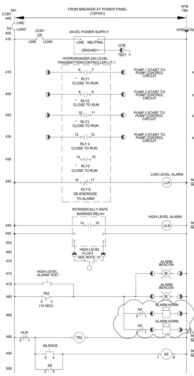
**B** LEVEL CONTROL SCHEMATIC LOCATED IN PUMP CONTROL PANEL
